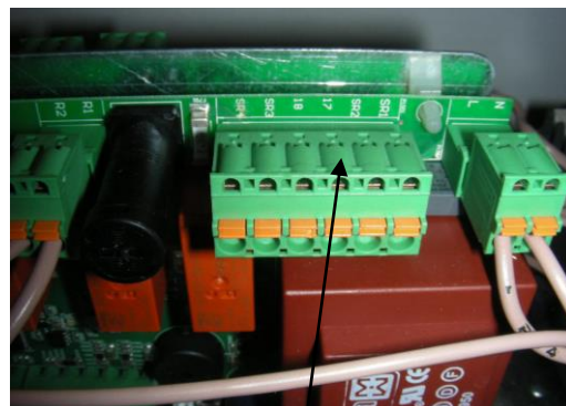
Repères des détecteurs SR1 et SR2 mais aussi 17 et 18 de la carte de circuits imprimés
