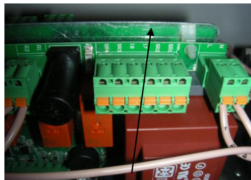
Piirikortilla olevat tuntoelimen liittimet SR1 ja SR2 sekä 17 ja 18
