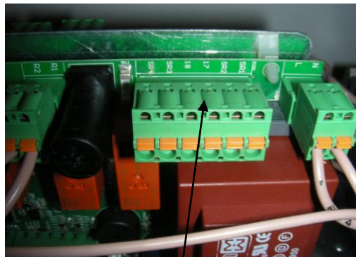
Marcadores de sensores SR1 y SR2 así como, el 17 y 18 de la placa del circuito
