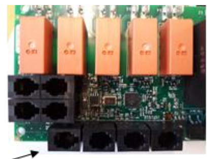
Рис 8 Расположение разъемов RJ 10. Датчик, дверной выключатель, дистанционное управление, дополнительный датчик NTC
