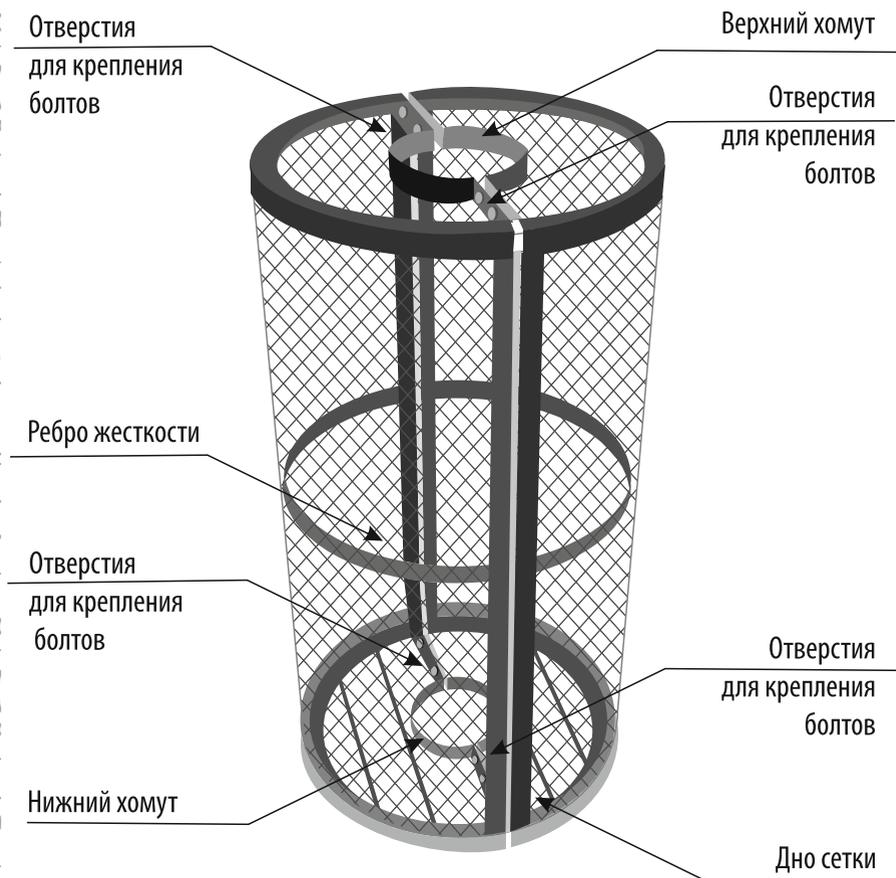
1. Поместите обе детали сетки с двух сторон от дымовой трубы, следя за соблюдением ориентации верх-низ (дно сетки для камней обязательно должно находиться со стороны присоединения дымохода к печи) и на расстоянии минимум 130мм от верхней точки купола печи:
