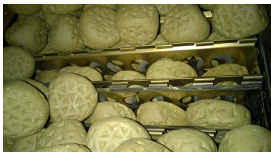
Контейнер, установленный в нагревателе, с камнями Tetra сверху.
